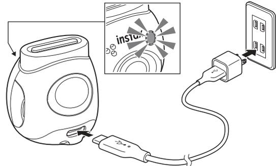
Verbinden Sie die Kamera über das mitgelieferte speziell dafür vorgesehene Ladekabel mit einem USB-Netzadapter (separat erhältlich) und verbinden Sie anschließend den USB-Netzadapter mit einer Steckdose.
