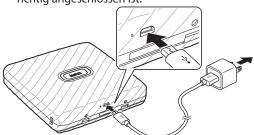
Verbinden Sie den Drucker über das mitgelieferte Mikro-USB-Kabel an einen USB-Netzadapter (im Lieferumfang Ihres Smartphones enthalten) an, und verbinden Sie anschließend den USB-Netzadapter mit einer Stromversorgung.
