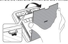
2 Greifen Sie die rechteckigen Löcher in der Filmpackung und entfernen Sie die leere Filmpatrone.
