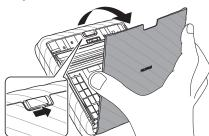
2 Legen Sie den Film ein, indem Sie die gelben Markierungen auf dem Film am Druckergehäuse ausrichten.
